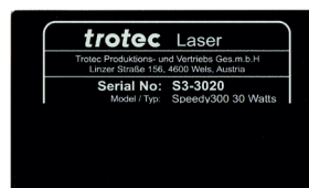
Gravering av typskylt i aluminium.
